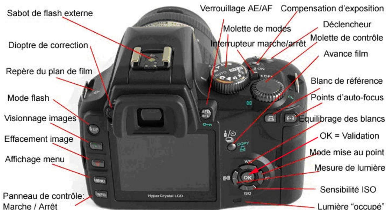
Le dessus de l'appareil abrite quelques un des contrôles essentiels :
